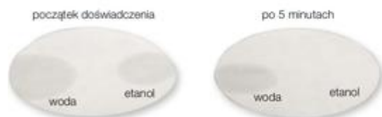
Fot. 97. Porównanie lotności etanolu i wody.
