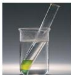
Fot. 99. Reakcja umożliwiająca wykrycie obecności alkoholu etylowego.
