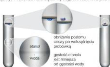
Fot. 95. Mieszanie etanolu z wodą.
